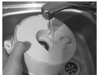
Nehmen Sie den Tank von der Station und legen Sie z. B. ein Geschirrtuch auf die Unterseite, damit keine Feuchtigkeit während des Reinigens in die Elektronik eindringen kann (Bild 1).
