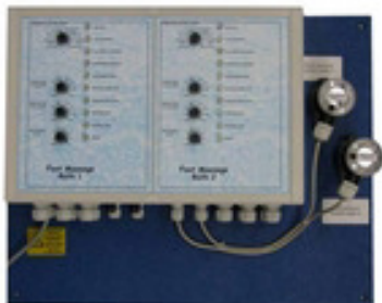
Gehäuse mit Mikroprozessorsteuerung
