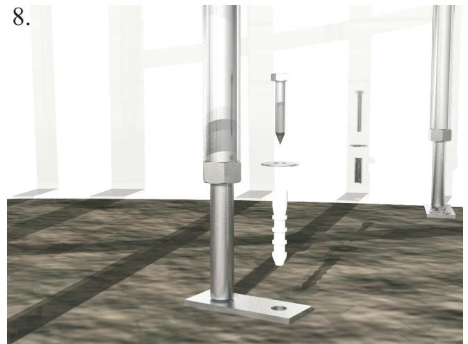
**Jeder Stütze mit PVC Dübel und mit Schrauben M8x50 ( liegen bei ) in Betonboden fest schrauben.**
