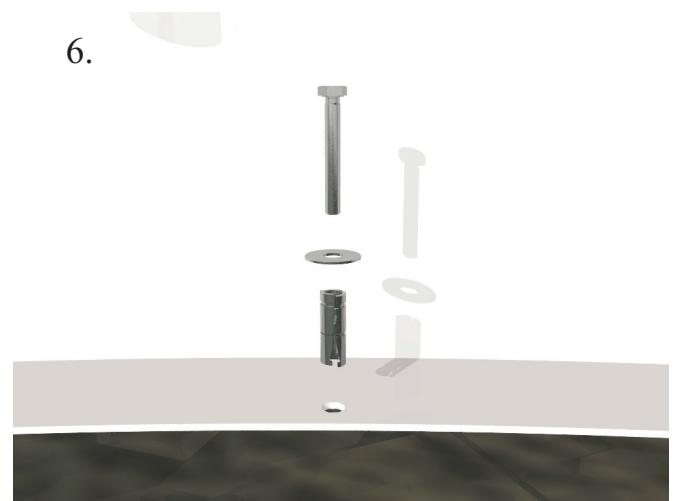
**Durch jede Bohrung in der Flansch Bohrungen in Beton machen, mit Eisendübeln und Schrauben fest schrauben.**
