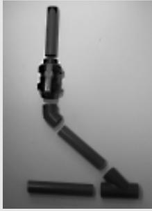
6. T-Stück für Vorlauf in die zum Becken führende Leitung einkleben. Kugelhahn (9) - Fallstrombremse – in die Vorlaufleitung kleben.
