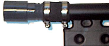
4. Entlüfter (8): Der Entlüfter muß in senkrechter Stellung an höchster Stelle montiert werden. Reduzier-T-Stück und Reduzierstück einkleben und Entlüfter mit Teflonband einschrauben.
