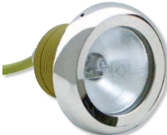
**Подводный осветительный прибор SPL<sup>III</sup>** для плавательных и гидромассажных бассейнов, прудов и фонтанов. При размере всего 100 мм его мощность достаточно большая, галогеновая лампа с фокусировкой в пределах 20 - 65°. Галогенные прожекторы намного мощнее обычных ламп, изготовлены из нержавеющей и термостойкой пластмассы (ПА 6.6, армированной стекловолокном). Прибор снабжен специальным кабелем длиной 2 м, рамкой из нержавеющей стали различного цвета или из поликарбонатной пластмассы.
