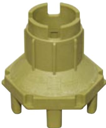
**Kontermutterschlüssel**, PA 6.6 glasfaserverstärkt, zur Montage von Kontermuttern (Befestigungssatz 3634, 828004), zur Verlängerung von Montageschlüssel 3401, zum Verschrauben von M20 x 1,5 Druckschraube der SSL Scheinwerfer und zum Einschrauben des SPLM - Gehäuse in die UNI DI 1¼".
