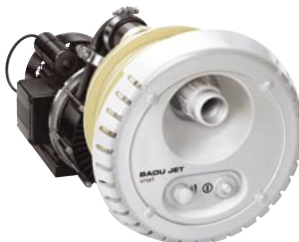
GSA BADU JET smart készreszerelő készlet komplett befúvóburkolattal, levegoszabályozóval és pneumatikus ki- és bekapcsolóval, 1 db gumikönyökkel d 63, 1 tömlisztorító készlettel, 1 csavarkészlettel, 1 kapcsolóegység IP 55 védelmi osztály szerint. A szivattyú teljesítménye 40/45 m<sup>3</sup>/h, pneumatikusan vezérelt, masszázsnyomás 1,6 bar.
