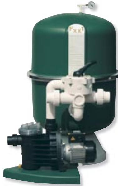
В установке F<sub>XX</sub>1-TS процесс фильтрации начинается там, где традиционные фильтры его заканчивают. Пройдя слой песка толщиной 350 мм, вода попадает в слой активированного угля толщиной 600 мм, а это вместе составляет уже 950 мм фильтрующего слоя. Все загрязнения, а именно:
