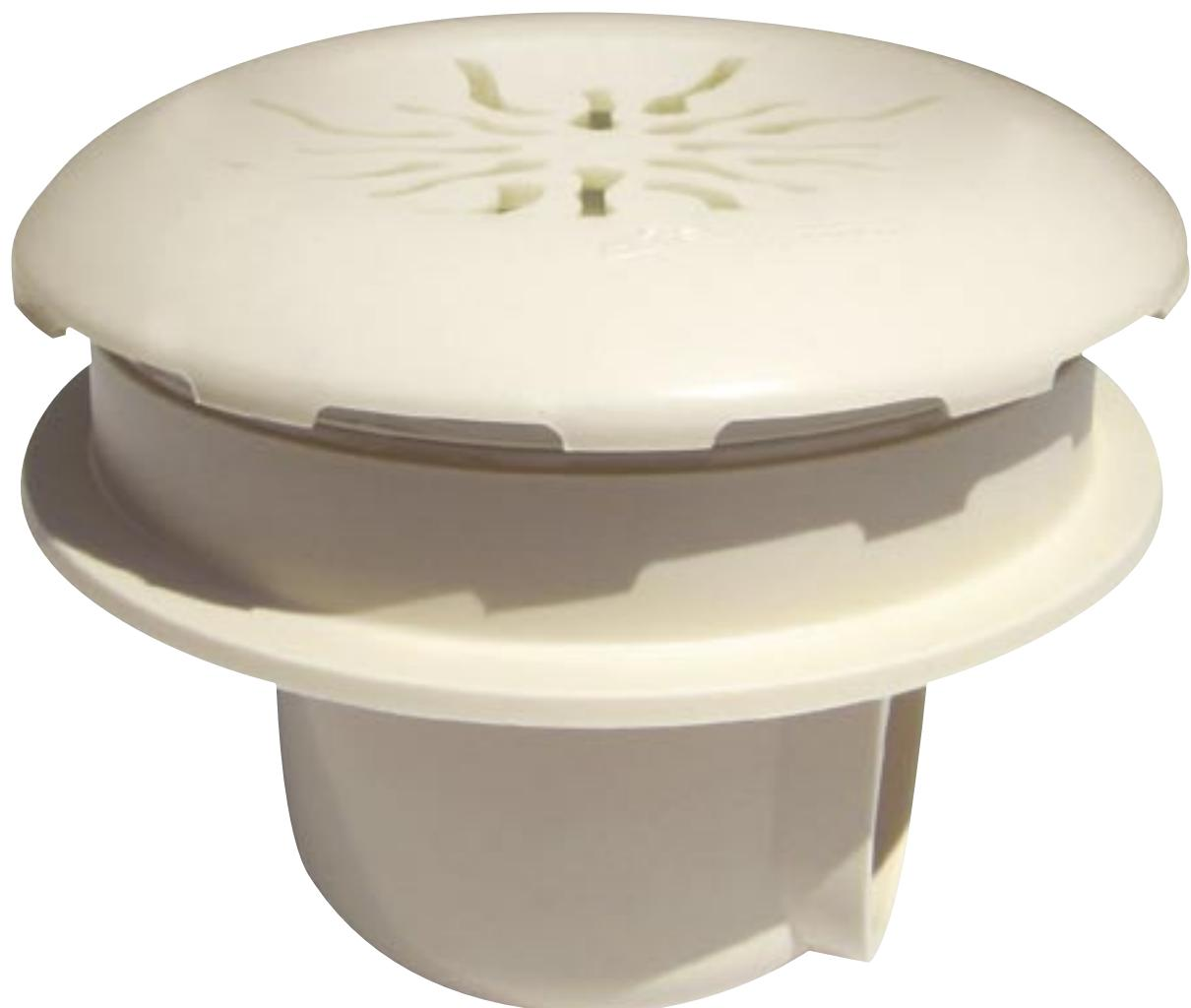
**Bodenablauf** ABS cw, mit 2 Abgängen: Waagerechter Innengewindeanschluss G 2", senkrechtes Außengehinde G 2½" bzw. Klebeanschluss Ø 63 mm innen. Beide Anschlüsse wählbar durch Verschlüsse mit Sollbruchstellen.
