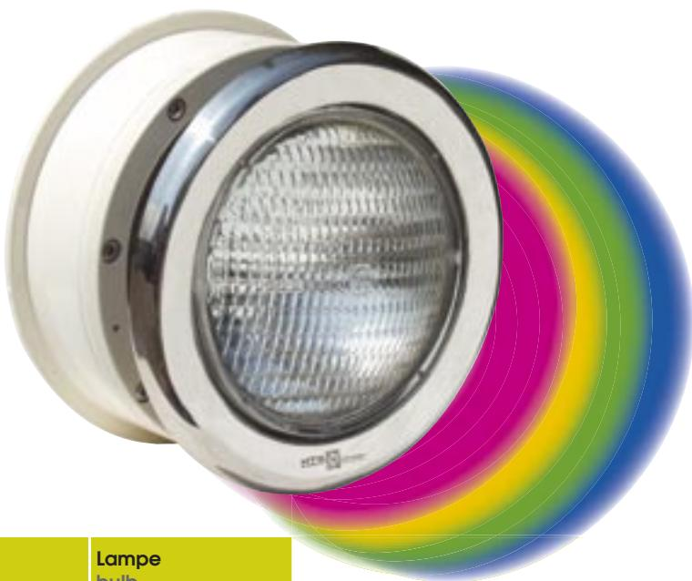
vízalatti világítótest BEB rozsdamentes acélból, 300 W/ 12 V, Grand Couleur RGB LED 21 W/ 12 V, betonmedencékhez, állítható fényforrás 3 m-es speciális vezetékkel. Niro V4A blende, Crowning eljárással gyártott masszív, nagy értékű, kézzel polírozva. A beépítőház krémfehér ABS-ból készült, szigetelt vezetékkel és vízmentes tömszelencével.
