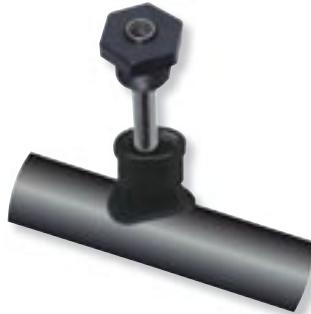
Погружаемое гнездо WT, 70 мм x 9 мм, нержавеющая сталь с самоуплотняющейся пробкой, резьбовое соединение  $\frac{1}{2}$ ", а также.
