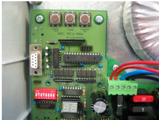
Bild: Programmier Tasten auf der Platine
