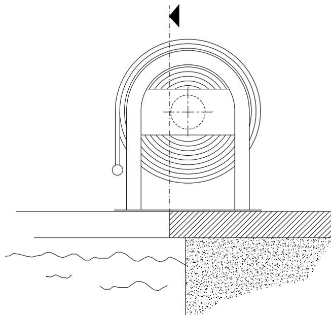
8. Nachdem die Abdeckung auf geraden Lauf kontrolliert wurde und das RONDALINO ausgerichtet ist, kann es am Boden fixiert werden.
