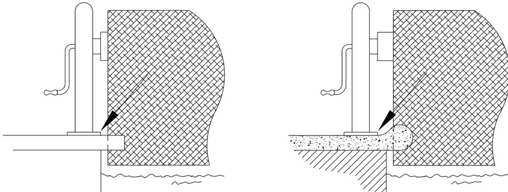
5. Jetzt können Sie das Keder am Netz der Abdeckung in die dafür vorgesehene Nut der Wickelwelle einziehen.
