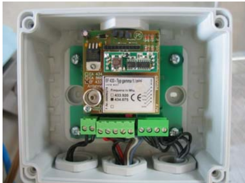
Abbildung: BAC-FIX Steuerung mit aufgesteckter Funksteuerung
