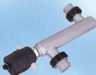
Gehäuse aus Titan, Heizstab aus Incoloy 825, mit Regelthermostat 0-40° C, Oberfläche lackiert, mit zwei PVC Klebeverschraubungen DN 40 und Kunststoffhalterungen.
