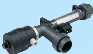
aus Edelstahl V4A, mit Regelthermostat 0-40° C und Druckschalter als Wassermangelsicherung\*, Oberfläche lackiert, mit zwei PVC Klebeverschraubungen DN 40 und Kunststoffhalterungen.
